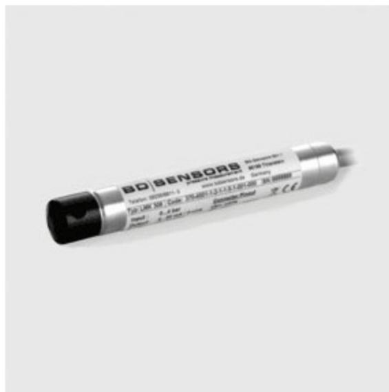
Погружной зонд LMK 306 сверхмалого диаметра (17 мм) с керамическим сенсором, предназначен для непрерывного измерения уровня жидкостей, неагрессивных к нержавеющей стали.
